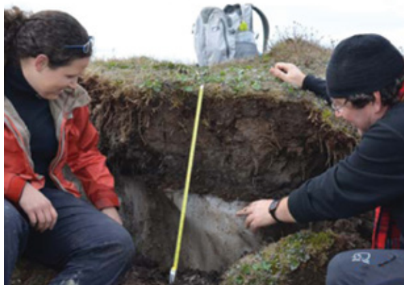
Мал. 2.8.7. Вертыкальны разрэз шматгадовамёрзлых парод з ледзянымі сляямі.
